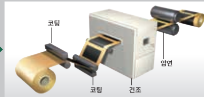
⑤ 코팅·건조·압연 전극재를 금속박에 균일하게 도포합니다. 도포된 전극재에 뜨거운 바람을 가하면 습기가 급속으로 흡인되어 빠르게 건조 됩니다. 전극을 롤러로 압연하여 밀도를 높입니다.
